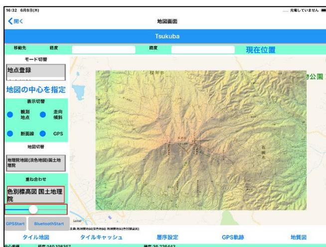
ネットワークに接続できない状態では、キャッシュされた標高タイルを使用して、走向傾斜登録、地点登録、断面図の作成、地質図作成等を行います。
