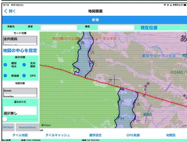
上盤/下盤それぞれに地層が構築されます。赤いラインは断層面と地表面の交線です。
