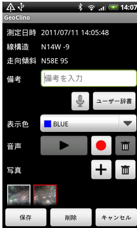
上部に測定日時・線構造・走向傾斜が表示されます(線構造は線構造測定モードで測定した場合のみ)。測定値に対して備考が入力でき、地図上への表示色も選択することができます。保存ボタンにより保存を行います。
