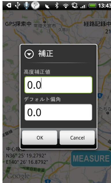
高度補正は GPS で取得される高度を補正する場合に入力します。偏角は通常 GPS から取得される値を利用しますが、GPS が利用できない場合はここで設定したデフォルト偏角を偏角として保存します。
